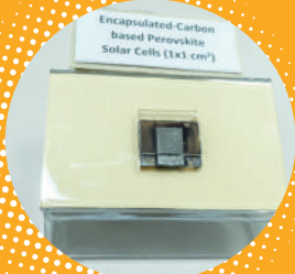
เซลล์แสงอาทิตย์ชนิดเพอโรฟสไกต์ขนาด 1x1 ตารางเซนติเมตร
